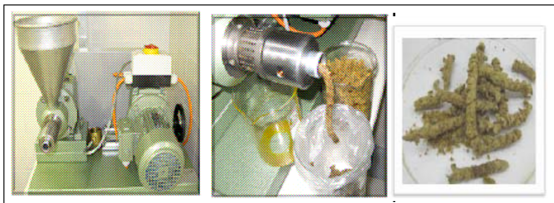
Figura 4.10 - Prensa contínua, tipo expeller , utilizada no processo de extração por prensagem combinada com hidrólise enzimática para a obtenção do óleo da macaúba e da torta.
